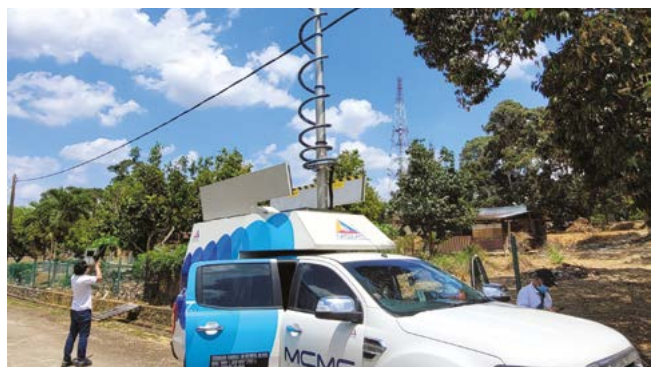
Rajah 7.33: Persediaan Pemantauan Pautan Gelombang Mikro
